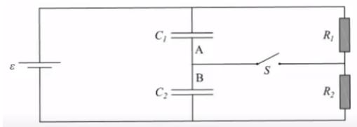
נתונים שני קבלי לוחות  $C_1$  ו- $C_2$ , ששטח כל לוח הוא  $0.02\text{m}^2$ . המרחק בין לוחות קבל  $C_1$  הוא  $1\text{mm}$  והמרחק בין לוחות קבל  $C_2$  הוא  $3\text{mm}$ .
